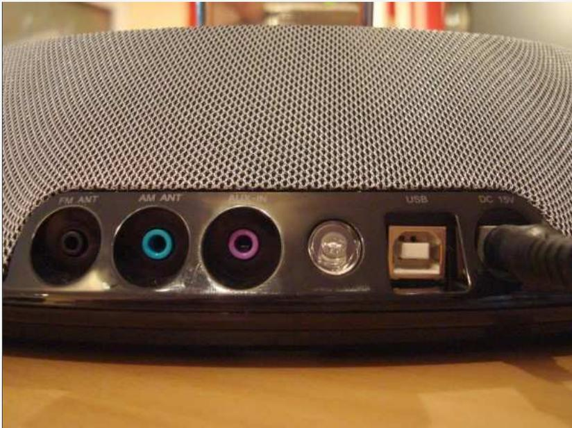
Anschlüsse auf der Rückseite: FM- und AM-Antennenanschluss, 3,5 mm Aux-Eingang, USB- und Netzteilanschluss
